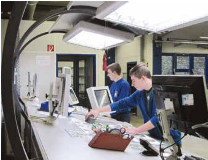
*An den mit Normlicht ausgestatteten Druckkontrollplatz
