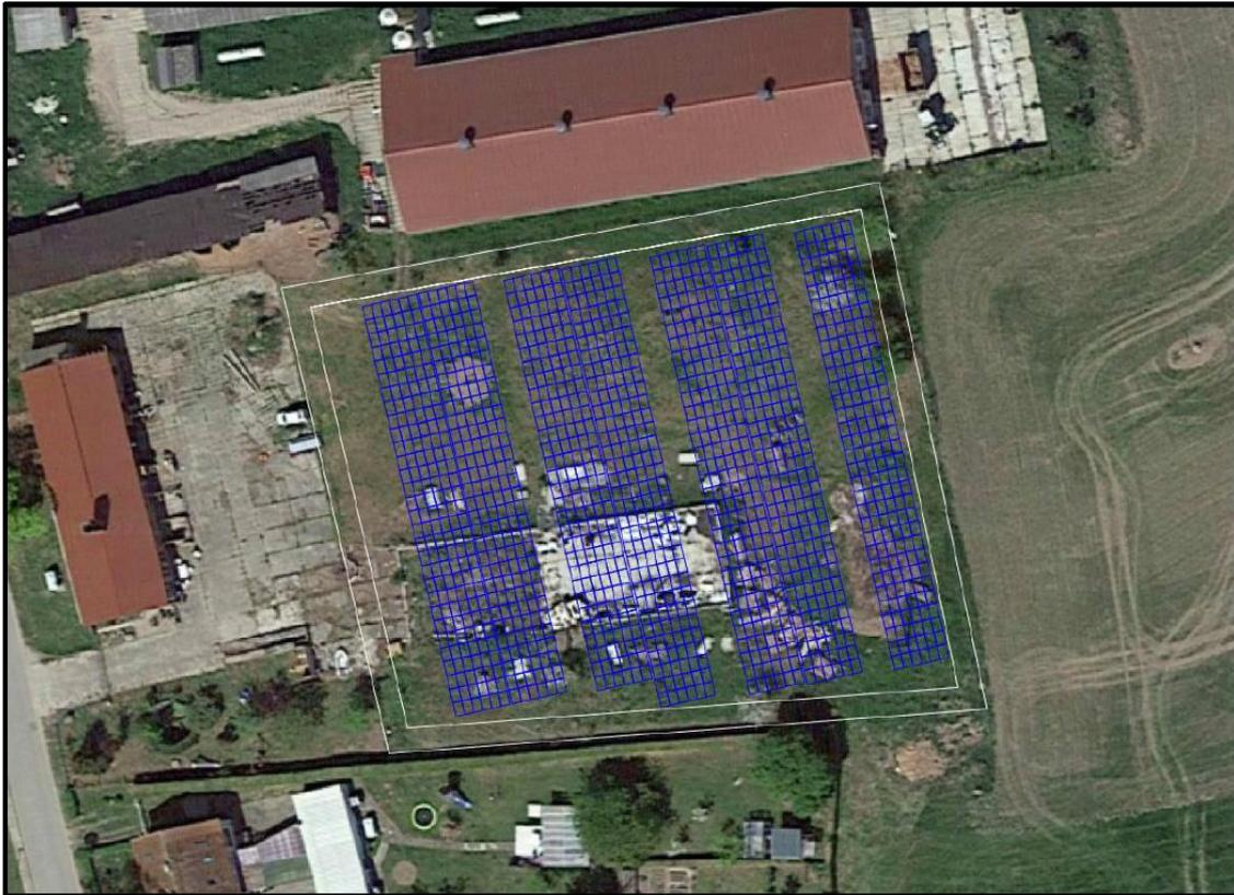
Abb. 5: Städtebauliches Konzept - Modulbelegungsplan (ohne Maßstab), Quelle: WI Energy
